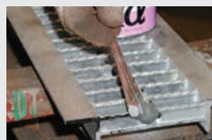
切断面や溶接部、めっき層が剥がれた箇所の補修に。
