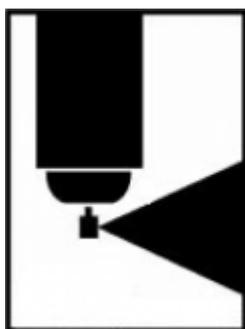
A：使用後すぐに逆さにし、2秒程度スプレーして横向きに保存してください。逆さに向けてスプレーすることによって、噴出ガスがチューブの中に残った塗料を掃除(除去)します。
